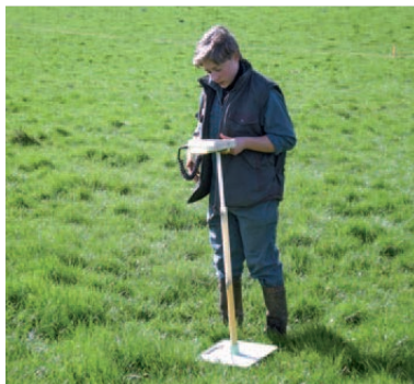
L'HerboMÈTRE® est l'outil de mesure des hauteurs d'herbe. On peut aussi avoir des repères visuels sur ses bottes! (voir p. 46)
