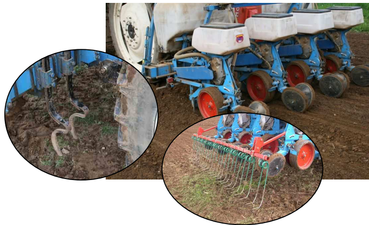
Exemple d'effaceurs de traces de roue : dents à l'arrière des pneus du tracteur et herse peigne à l'arrière du semoir
