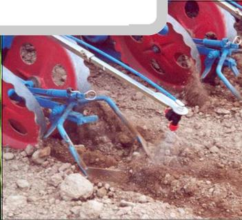
**La pulvérisation associée au binage** (désherbinage) associe deux techniques qui requièrent des conditions d'application légèrement différentes. Les faibles débits de chantier et la sensibilité des réglages (bineuse et pulvérisation) représentent un frein à l'utilisation de cette technique.
