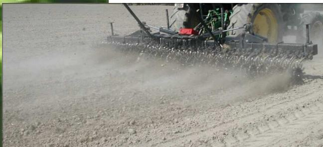
En tournant à haute vitesse, les roues projettent les particules du sol et permettent de déraciner les mauvaises herbes en les enterrant et les desséchant en surface.
