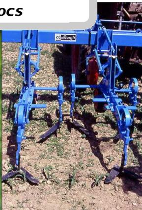
Les **bineuses à socs** permettent d'intervenir dans les rangs lorsque les adventices sont plus développées que lors d'utilisation de herse étrille ou houe rotative. On distingue le déchaussage près du rang et le buttage avec des socs ou des disques. Au premier passage, il est nécessaire de protéger les jeunes plants des projections de terre en montant un "protège-plants" le long des rangs.
