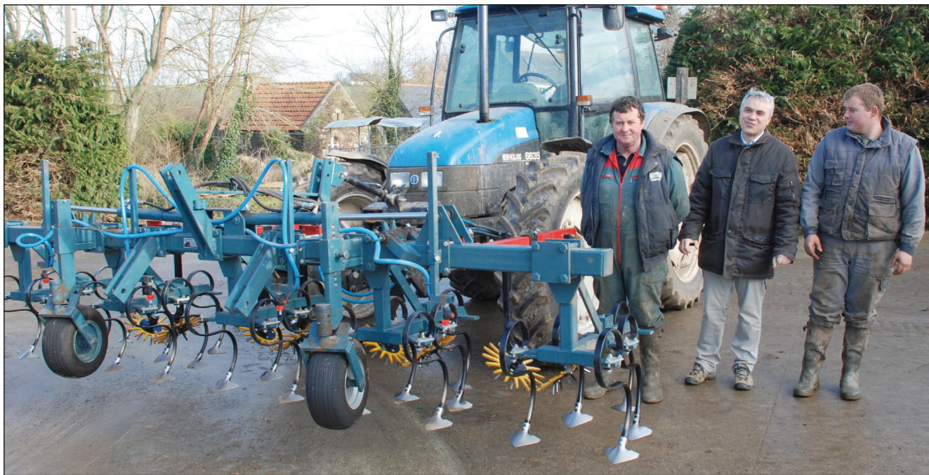
Alain Penn (à gauche) et son fils Nicolas, autour de Vianney Estorgues, ingénieur à la Chambre d'agriculture 29. À côté, la bineuse complète quatre rangs, avec possibilité d'attelage à l'avant du tracteur, et buses pour traitement localisé.
