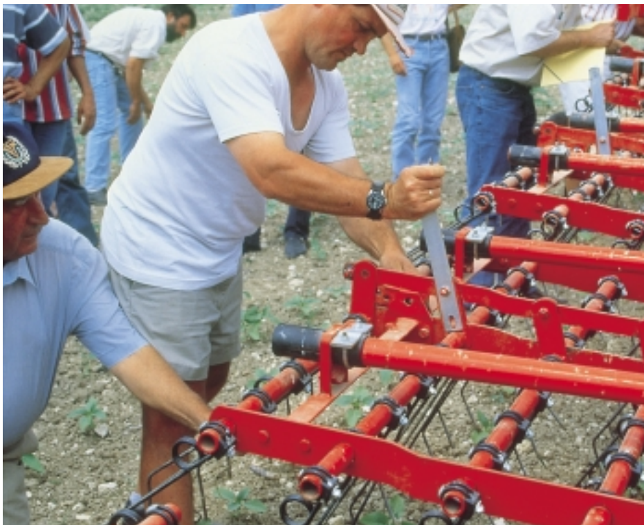
Réglage de l'agressivité des dents de la herse étrille (CETIOM)
