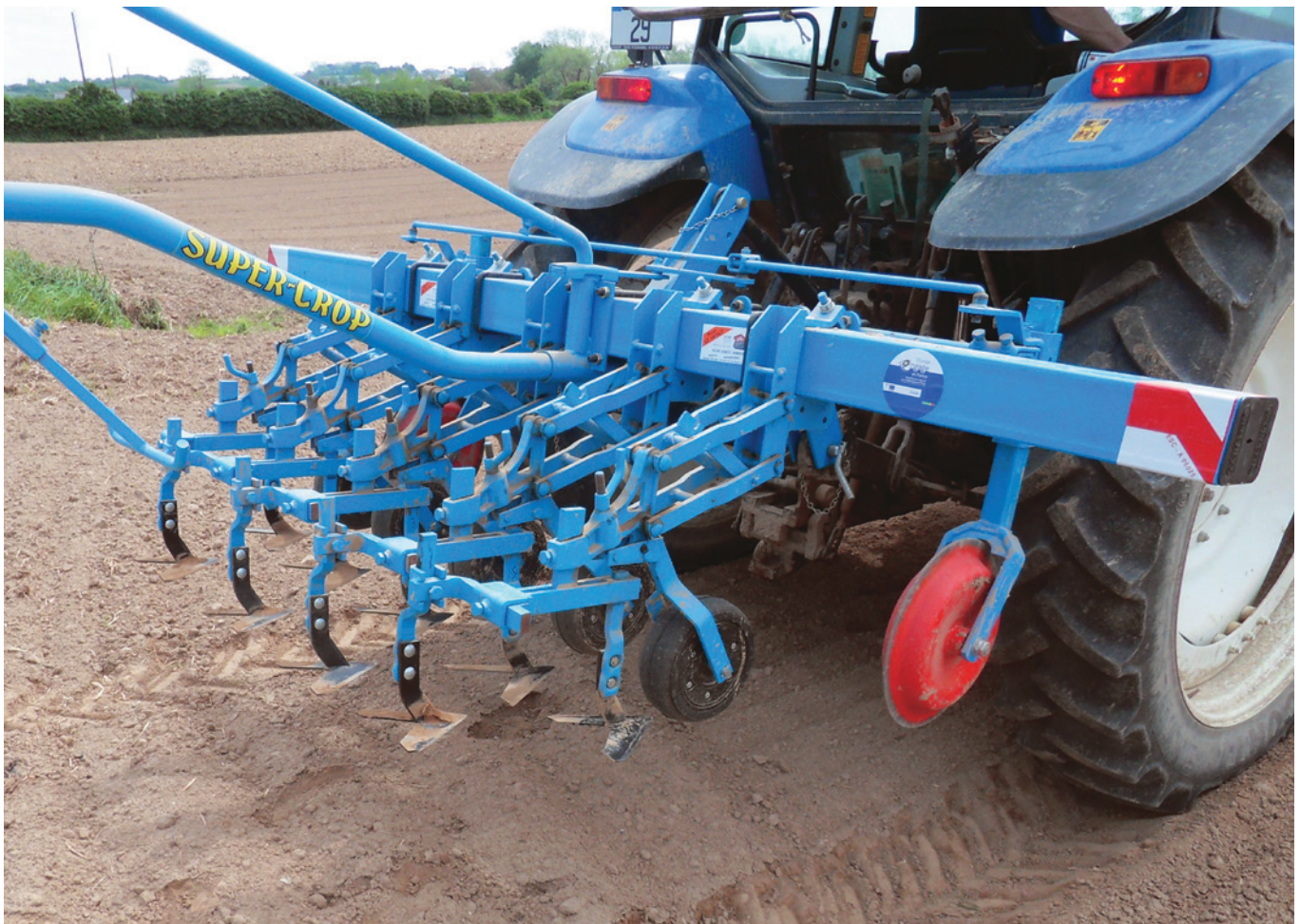
La bineuse patte d'oie qui travaille à 3 cm de profondeur a donné les meilleurs résultats
