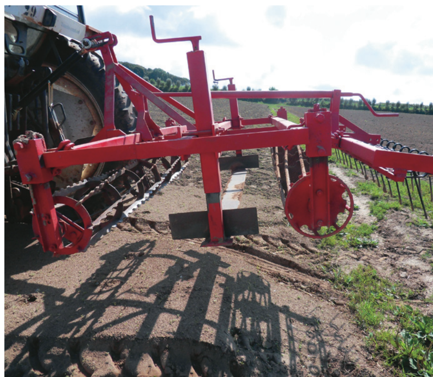
Pour les cultures en planches, un combine rouleau/lame/étrille permet un travail très superficiel particulièrement adapté à la technique du faux semis
