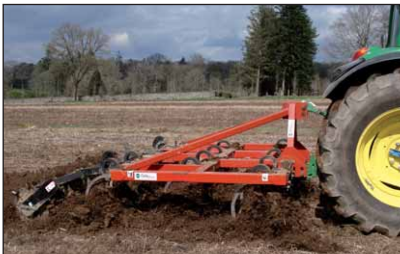
Le chisel, matériel fréquent dans les exploitations peut être utilisé en non labour.
