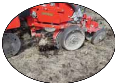
Le rotasemis permet de préparer la bande de semis pour l'implantation du maïs.
