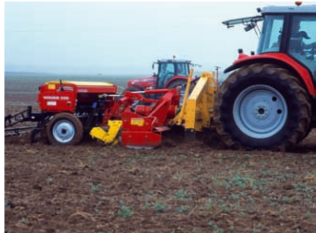
Semis avec combiné décompacteur-semoir
