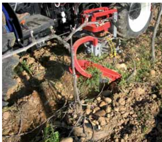
Porte-outil Egretier monté entre roues avec régulation de la profondeur
