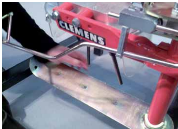
Lame intercep Clemens équipée d'une herse verticale
