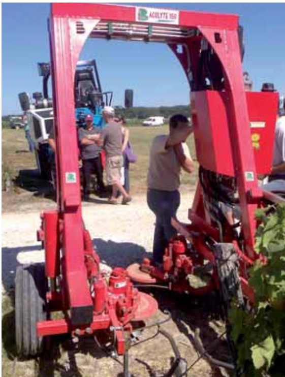
Deux modules Starmatic Boisselet montés sur le châssis enjambeur tracté Acolyte
