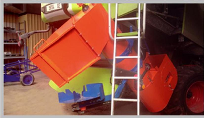
Kit andaineur à monter sur le crochet d'attelage de la moissonneuse batteuse équipée d'un éparpilleur hydraulique + 1 kit hydraulique
