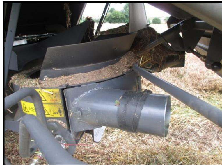
Inversion de la rotation des éparpilleurs sur Claas et canalisation dans tuyaux
