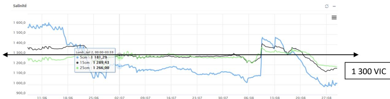
Les salinités à 15 et 25 cm sont comprises du 18 juin au 9 août entre 1 300 et 1 200 VIC. La pluie du 9 août fait remonter des niveaux de VIC, cet apport d'eau remet les éléments en solution dans le sol.
