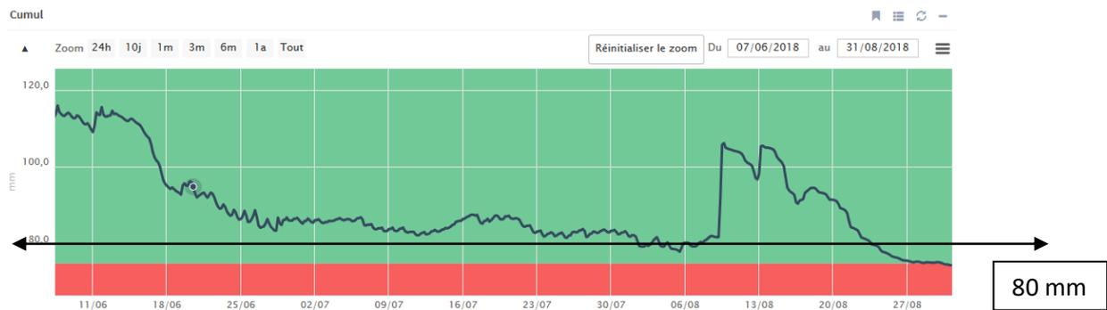
La courbe des cumuls est assez régulière, le pilotage de l'irrigation est maîtrisé. Après le 15 juin les températures augmentent fortement les consommations, l'irrigation est maintenue en dessous des besoins afin de laisser les racines descendre dans le sol, de ce fait la courbe des cumuls baisse. L'irrigation maintient ensuite la courbe dans le bas de la zone verte, jusqu'à atteindre 80 mm début août.
