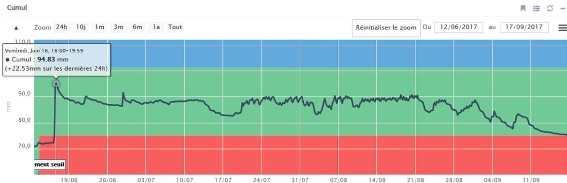
La courbe des humidités cumulées est dans l'ensemble assez régulière. Les humidités ont été facilement maîtrisables du fait d'une évaporation limitée grâce au paillage plastique. La variabilité du capteur 5 cm impacte moins la courbe des cumuls. A partir du 21 août la courbe baisse jusqu'à atteindre la zone de stress hydrique en fin de culture.
