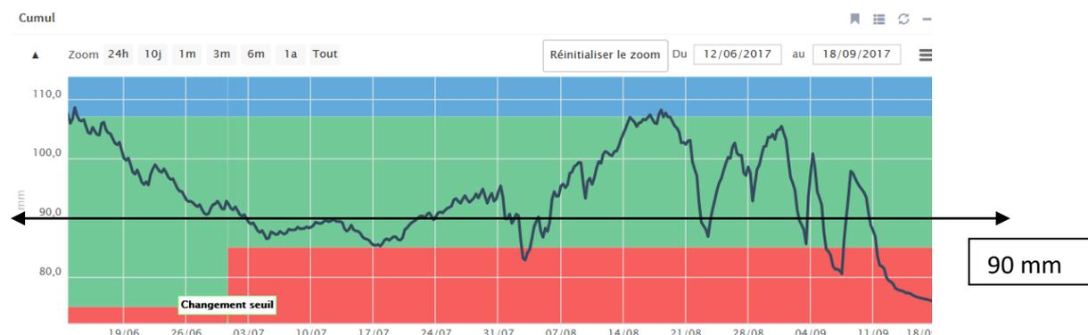
La courbe des cumuls représente l'humidité du sol en mm, sur l'horizon 0 – 25 cm de profondeur (extrapolation de l'humidité par les 3 capteurs d'humidité à 5 cm, 15 cm et 25 cm).
