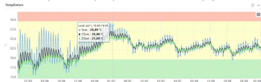
Les températures sous paillage au 1<sup>er</sup> juillet entre 16h et 20h sont à 15 cm de 26,86°C et à 25 cm de 25,69°C.
