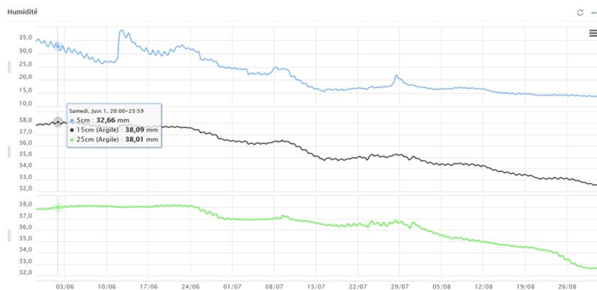
Les courbes des humidités évoluent similairement, la culture est maintenue dans un niveau de grand confort hydrique jusqu'au 29 juillet avec une humidité à 15 cm ne descendant pas en dessous de 34 mm, ce qui représente une situation très confortable. A 25 cm, les humidités sont restées au dessus de 36 mm.
