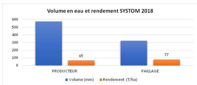
Une économie d'eau de plus 42% a été atteinte sur la modalité paillage plastique tout en maintenant le rendement. Ce résultat a pu être modifié par la pluie du 9 août, **aussi nous considérons qu'une économie d'eau de plus de 20% est possible avec la mise en place d'un paillage plastique.**
