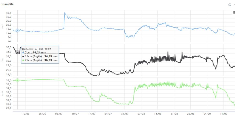
Les courbes à 15 cm et 25 cm évoluent de manière similaire, avec des niveaux d'humidité compris entre 24 et 30 mm du 17 juillet au 31 juillet, ce qui représente une humidité très modérée pour ce type de sol. Le contrôle à la tarière a montré un sol séchant.
