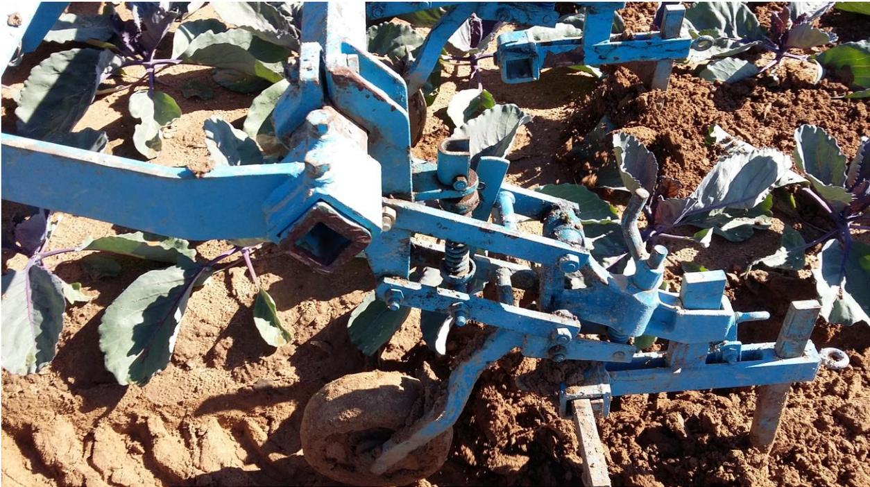
La profondeur optimale des lames est d'environ 2 cm et le réglage se fait au moyen de la roue.
