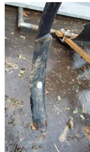
une action de buttage pour étouffer les adventices sur le rang. Cependant, si la culture est fragile et qu'on ne vise pas d'action de buttage, il existe des demi-socs qui permettent une action de scalpage proche du rang ne générant pas de buttage ou de recouvrement. Les socs triangulaires peuvent être plats (et donc parallèles au sol). Dans ce cas, leur action est proche de celle des lames.
