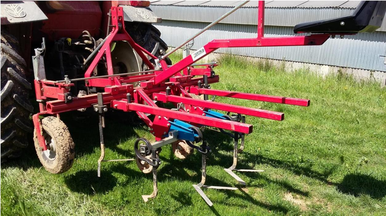
Il s'agit de bineuses simples, pourvues d'un système de guidage manuel permettant le contrôle latéral des éléments bineurs par rapport au tracteur. L'opérateur, assis derrière la bineuse, peut agir sur un levier de guidage.
