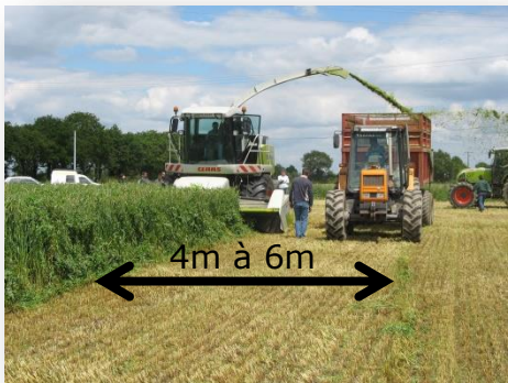
Différence de largeur de coupe en fonction du matériel utilisé *peut être différent de la largeur entre les andains, avec ou sans regroupeur
