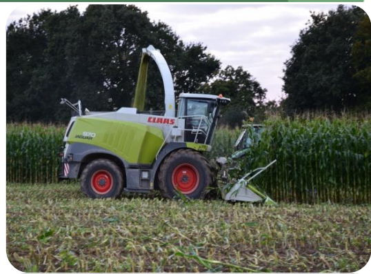
Photo d’une ensileuse avec bec à maïs pendant la récolte
