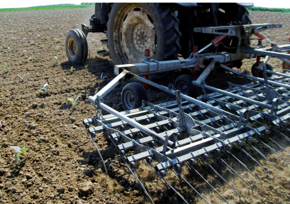
La herse étrille, l'outil qui a donné les moins bons résultats dans nos essais (ici sur artichauts)
