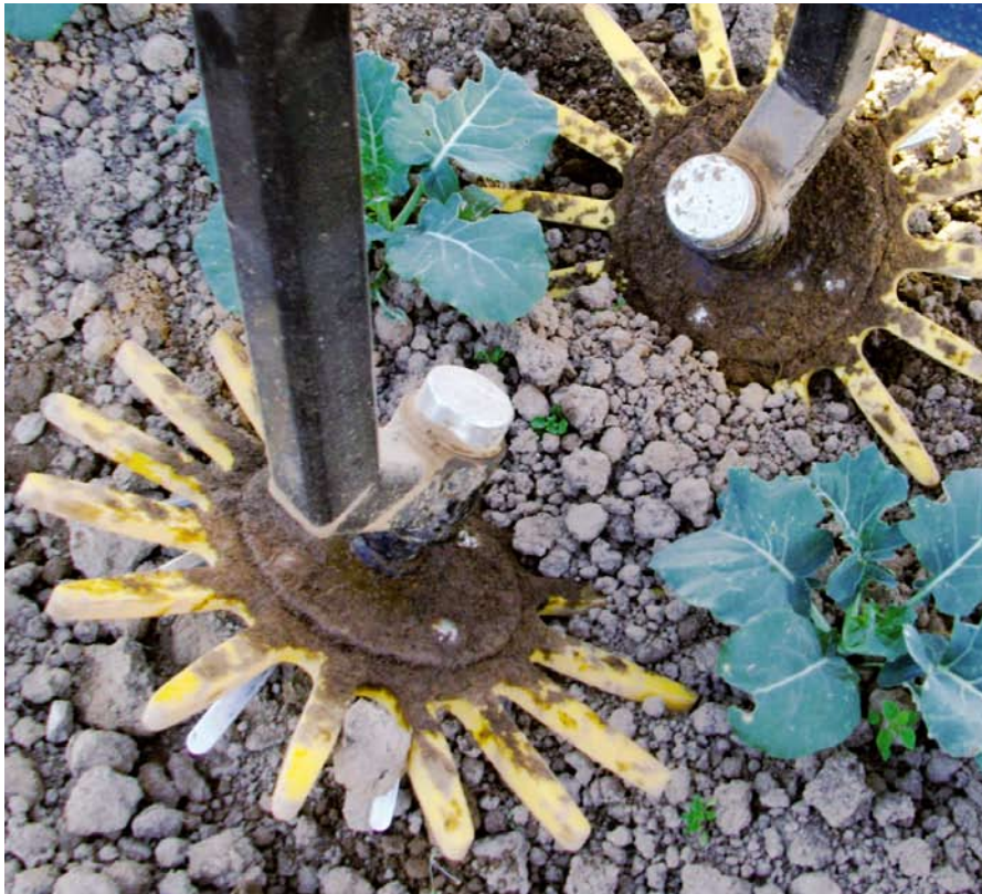
La bineuse « kress », outil le plus efficace mais qui demande le plus de précision
