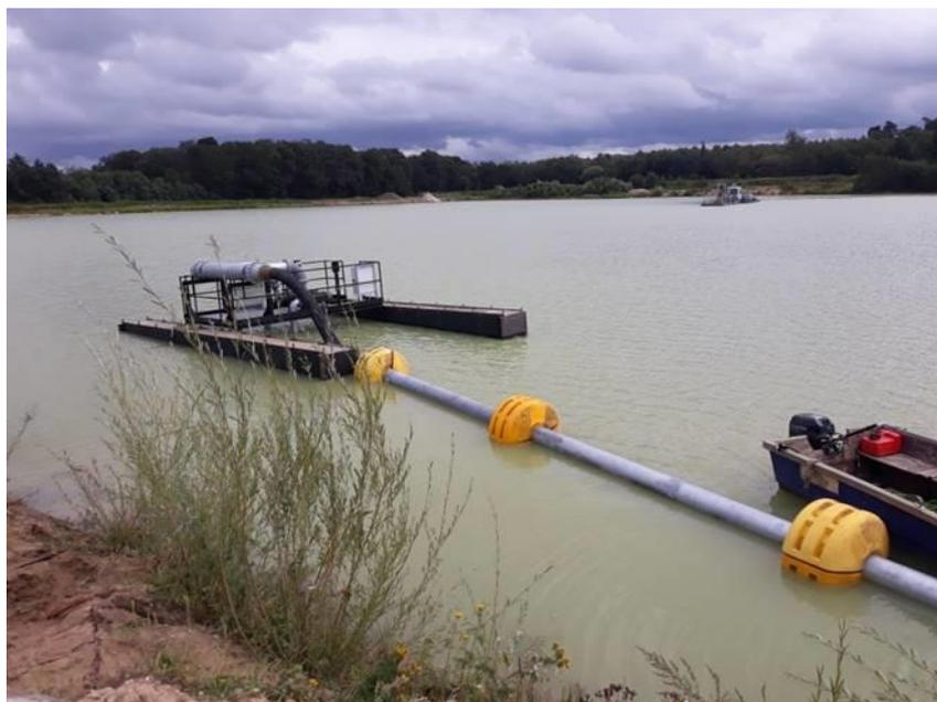
Figure 9 : Dispositif de pompage flottant pour l'irrigation sur une gravière
