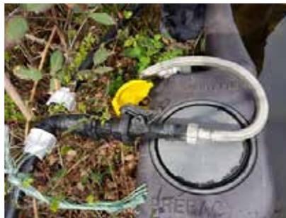
Raccord en push/pull avec le bac à eau
