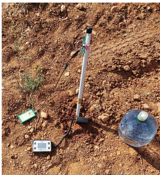
Figure 4 : Test de saturation en eau du sol
