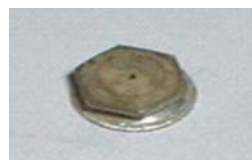
Un injecteur usagé démonté
