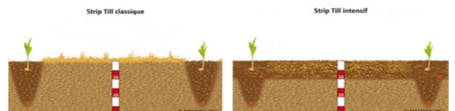
Figure 6 : Différence entre le Strip-Till classique et le Strip-Till intensif. Source : AMAZONE 2013
