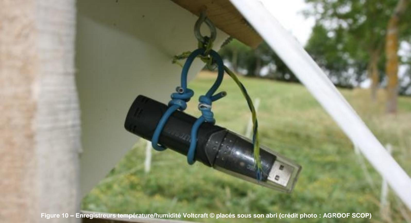
Figure 10 – Enregistreurs température/humidité Voltcraft © placés sous son abri (crédit photo : AGROOF SCOP)
