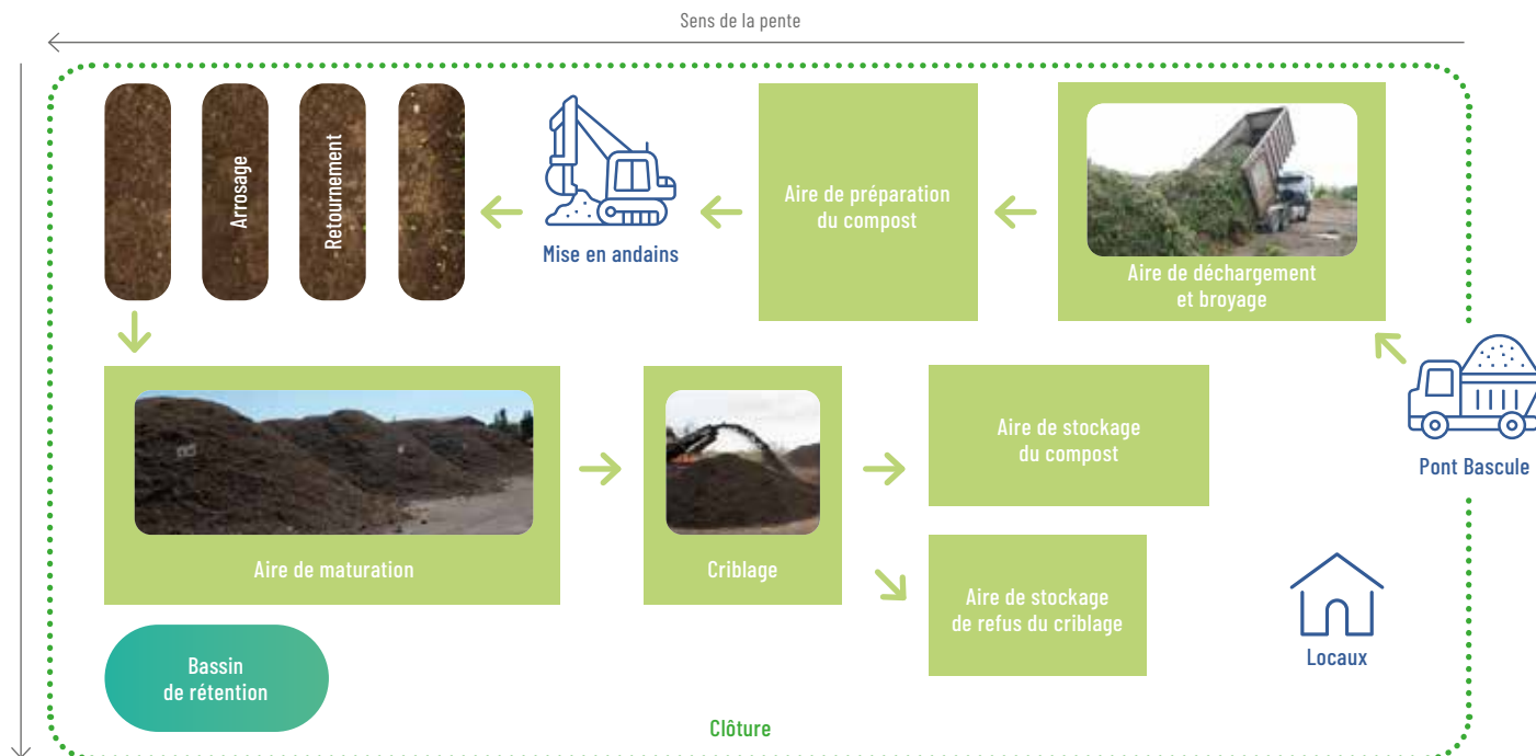
Figure 8 • Organisation d'une plate-forme de compostage (Chambre régionale d'agriculture Occitanie)
