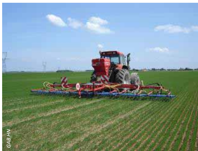
Herse étrille associée au semoir dans le lin
