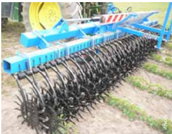
Gros plan d'un houe rotative (dans du soja)
