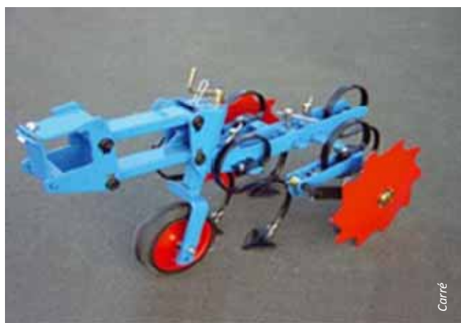
Détail d'un élément bineur à 5 pièces travaillantes
